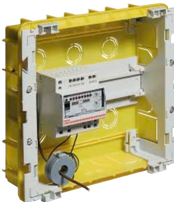
Inserire il cavo di fase dell'impianto da controllare nell'apposita sede prevista nel trasformatore TA in modo che venga letta la corrente totale assorbita dall'impianto. Essendo completamente isolato, il trasformatore può essere installato nel centralino oppure in una generica scatola di derivazione.
